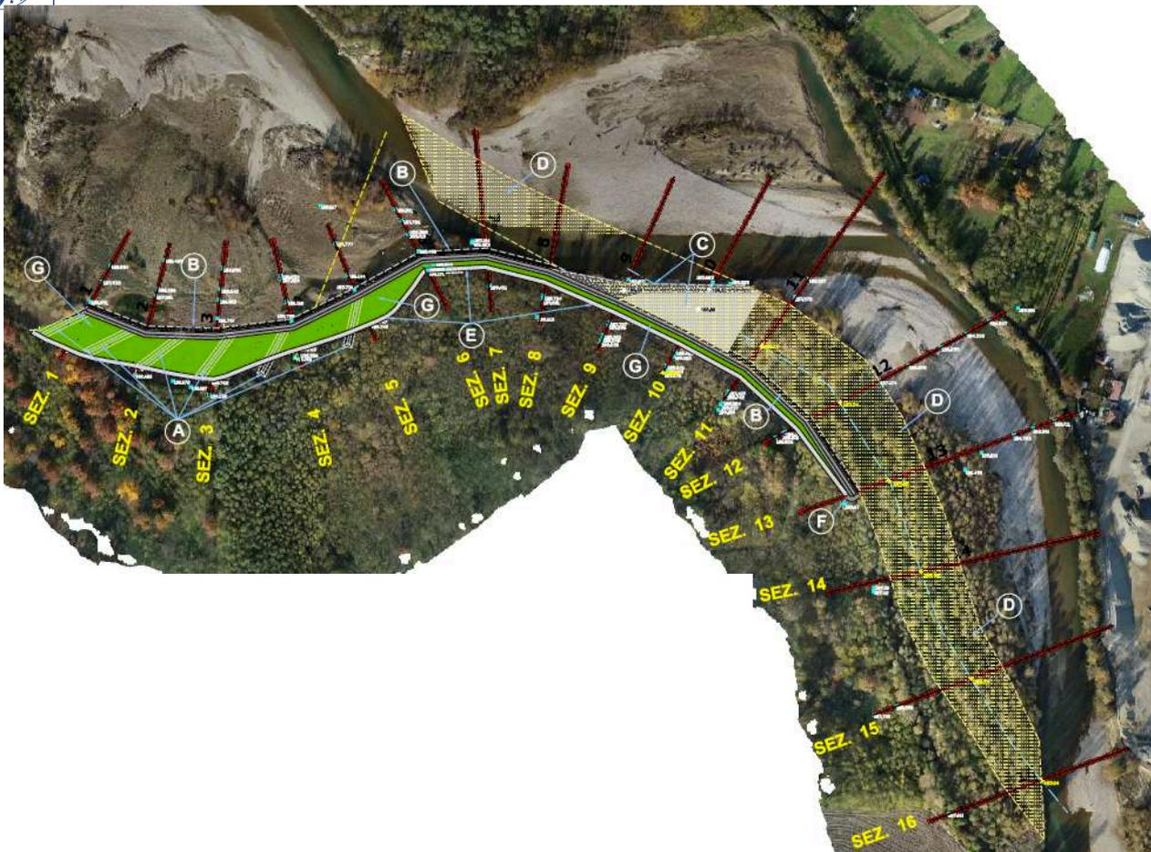
Figura 5.2: Planimetria definitiva degli interventi del 1° Lotto. A: Pennelli in cassero. B: Scogliera in massi. C: Corazzamento della zona di sfioro. D: Realizzazione nuovo canale. E-F: Pista di manutenzione. G: Sistemazione finale e inverdimento.
