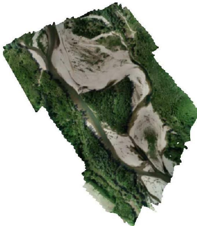
**Figura 4.2: Ortofoto del rilievo effettuato in Maggio 2020 nei pressi del salto di meandro avvenuto in località Montanaro**
